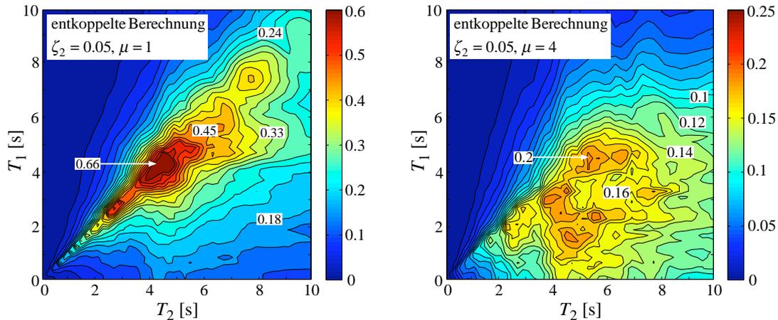
Abbildung 6: Median der Verschiebungs-Floorspektren,  $\zeta_2 = 0.05$ ,  $\mu = 1$  (elastisches System) bzw.  $\mu = 4$ . Entkoppelte Lösung.
